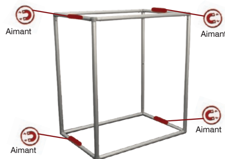
Aimants positionnés de chaque côté de la structure pour connecter 2 comptoirs ou plus
