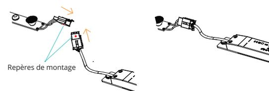
**5** Relier le cordon d'alimentation au courant électrique en utilisant le passe-câble du cadre
