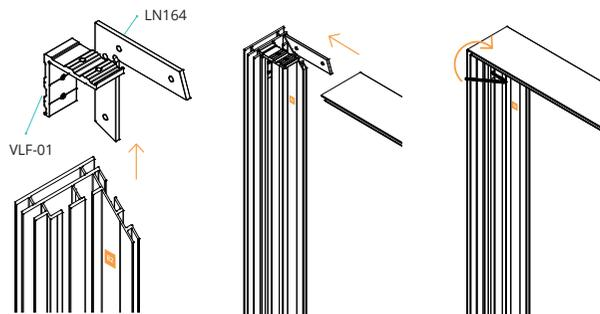
**2** Assembler les sections droites à l'aide des connecteurs et des repères de montage
